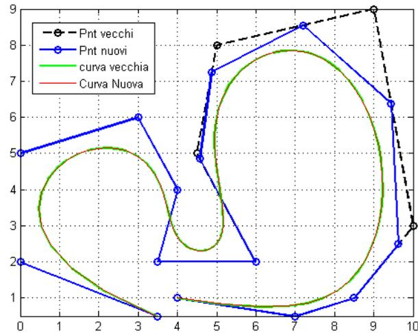
Figura 7: Esempio di inserimento di un nodo  $t = 0.75$  e  $p = 5$ .
