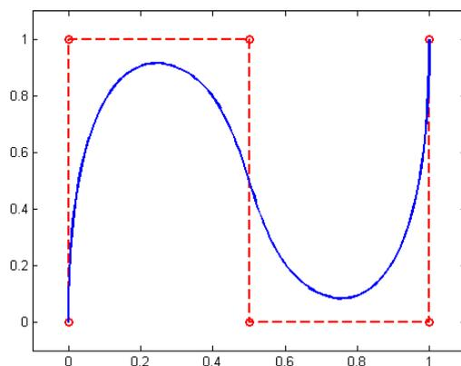
Figura 2: Esempio di B-Spline di grado 3.
