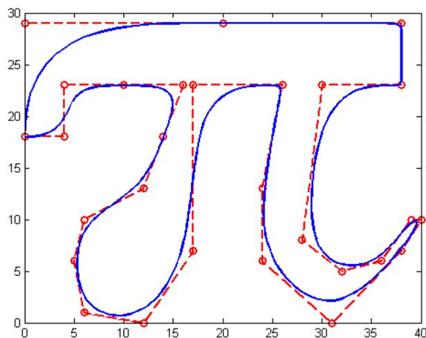
Figura 1: Esempio di approssimazione di  $\pi$  (carattere) con b-spline di grado 3.
