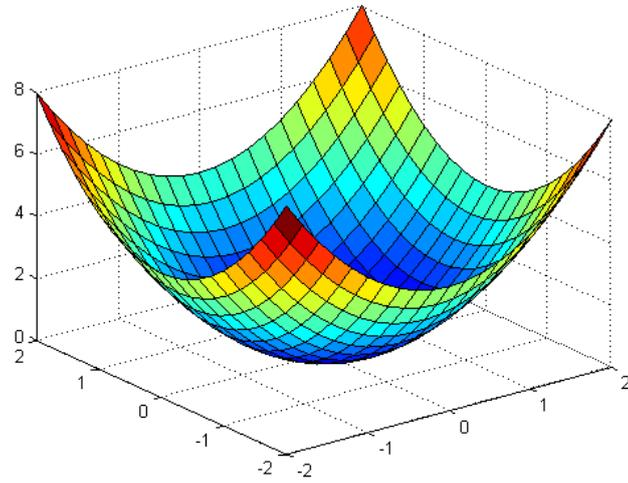
Figura 10: Interpolazione RBF con multiquadratica inversa e  $\epsilon = 10^{+1}$ .
