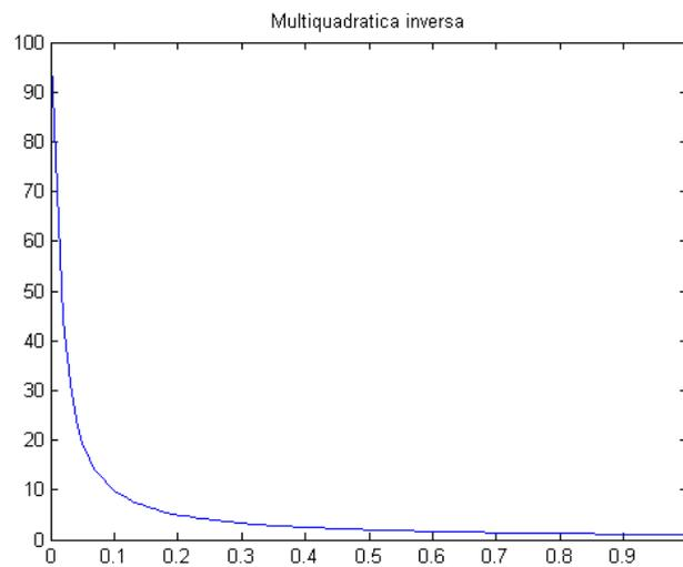
Figura 2: Esempio di funzione base multiquadratica inversa.
